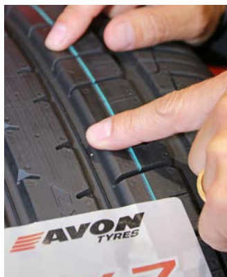
Die Noppen auf der Reifenoberfläche reduzieren die Abrollgeräusche.
