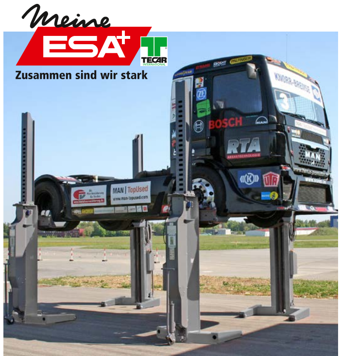
Die mobile Radgreif-Hebeanlage von Finkbeiner im Einsatz.
