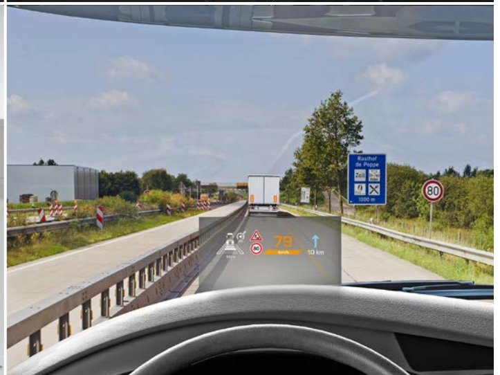
Continental bringt das aus vielen PW bekannte Head-up-Display in den Lastwagen. Die Technologie wurde im Innovationstruck verbaut und projiziert wichtige Fahrinformationen als farbiges Bild in das Sichtfeld des Fahrers. Kunden können entscheiden, ob die Anzeige im oberen oder unteren Sichtfeld eingeblendet wird.
