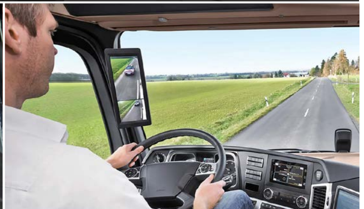
Kameras und Monitore statt Spiegel: Gleich mehrere Hersteller und Zulieferer präsentierten quasi das Ende des klassischen Seitenspiegels – zugunsten der Sicherheit und der Aerodynamik. Bis zu acht Kameras am Lastwagen liefern Bilder auch von toten Winkeln wie vom Bereich direkt vor der Motorhaube, der für den Fahrer kaum bis gar nicht einsehbar ist. Gezeigt werden die Bilder dem Chauffeur auf grossen Monitoren in der Kabine. Weil die Kameras aerodynamischer sind als die teilweise serviertablettgrossen Aussenspiegel, dürften sie Spiegelkamera-Systeme den Spritverbrauch um ein bis zwei Prozent verringern.
