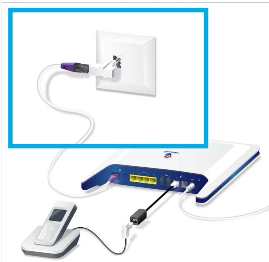
Nach der Umstellung wird das Telefon nicht mehr wie bisher an der Buchse in der Wand angeschlossen, sondern direkt am Internet-Router.
